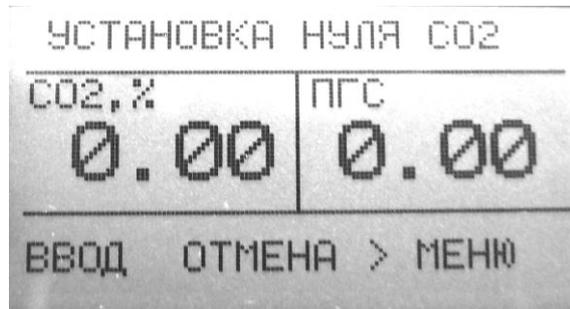
Слева отображается измеренное значение концентрации  $\text{CO}_2$ . Для установки нуля дождаться установления показаний и нажать кнопку «ВВОД». В случае успешной установки в нижней части индикатора появится надпись: «Выполнено!». Для выхода из этого режима без проведения установки нуля необходимо нажать кнопку «МЕНЮ».
