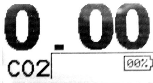
Для выхода из этого режима нажать кнопку ВВОД. Также прибор автоматически выходит из этого режима по истечении двух минут.
