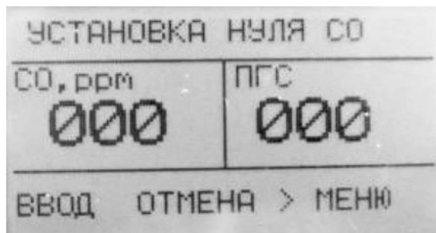
Слева отображается измеренное значение концентрации CO. Для установки нуля дождаться установления показаний и нажать кнопку «ВВОД». В случае успешной установки в нижней части индикатора появится надпись: «Выполнено!». Для выхода из этого режима без проведения установки нуля необходимо нажать кнопку «МЕНЮ».
