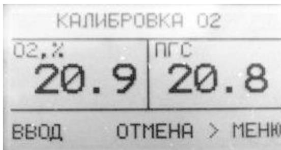
Слева отображается текущий результат измерения концентрации, а справа - введенное ранее значение ПГС. При помощи кнопок «+» и «-» можно установить значение используемой ПГС. Подать ПГС в соответствии с пунктом 3.3.1 данного руководства. Наблюдая за значением слева, дождаться установления стабильных показаний и нажать кнопку «ВВОД».
