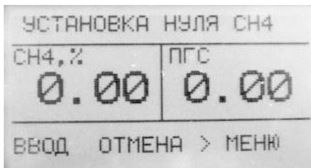
Слева отображается измеренное значение концентрации метана. Для установки нуля дождаться установления показаний и нажать кнопку «ВВОД». В случае успешной установки в нижней части индикатора появится надпись: «Выполнено!». Для выхода из этого режима без проведения установки нуля необходимо нажать кнопку «МЕНЮ».
