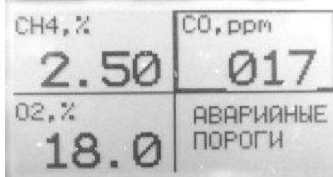
Настраиваемый порог выделяется рамкой. Его регулировка осуществляется нажатием кнопок «+» или «-». Подтвердить введенное значение нажатием кнопки «ВВОД», после чего рамкой будет выделен порог для следующего контролируемого газа, процедура настройки которого аналогична.
