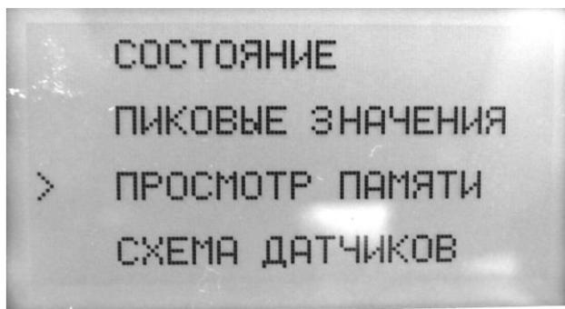
Пункт «Состояние» отображает напряжение батареи и время работы прибора с момента включения, а после следующего нажатия кнопки «ВВОД» текущие пороги срабатывания аварийной сигнализации.
